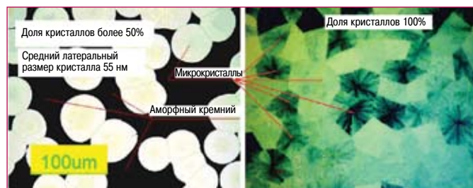
Рис.2 Процессы образования кристаллов кремния на стеклянной подложке
