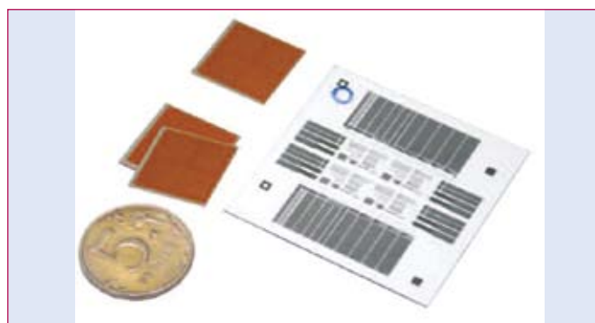
Рис.1 Полупроводниковые тонкопленочные структуры кремния для электронных приборов
