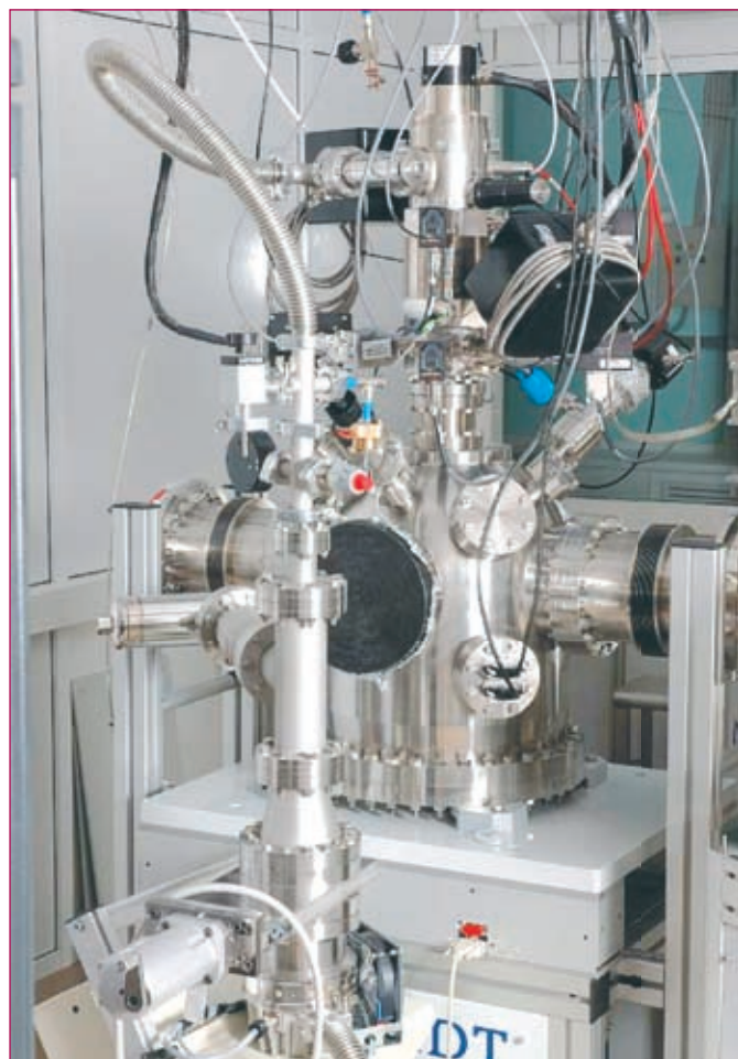
Рис.4 НАНОФАБ 100: модули FIB Implant + SEM + SIMS
