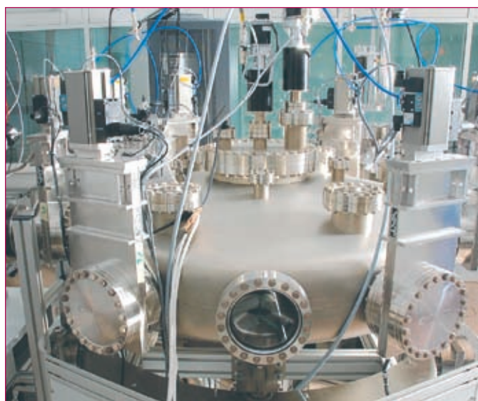
Рис.6 НАНОФАБ 100: транспортный модуль 6-ти позиционного робота
