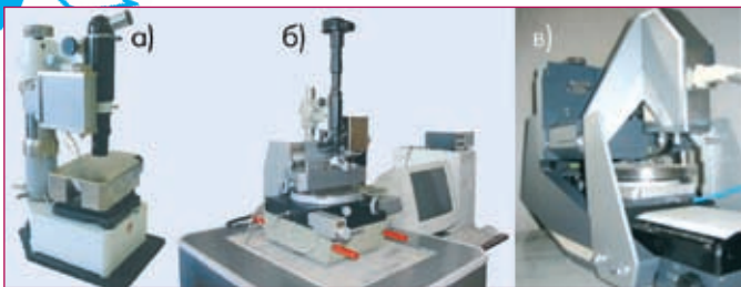
Рис.4 Нанотестеры Тамбовского государственного университета на базе микротвердомера ПМТ-3 (а), инструментального микроскопа ИМЦЛ-150-50 (б) и атомно-силового микроскопа SOLVER-LS (в)
