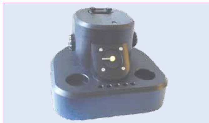
Рис.6 Биохимический анализатор на основе микрокантилеверных преобразователей
