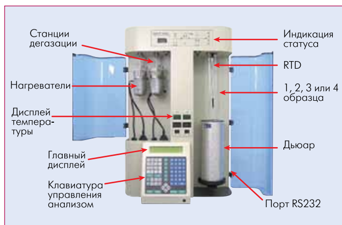
Рис.2 Устройство прибора NOVA
