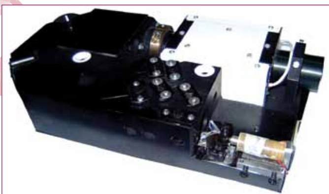
Рис.1 Моноблок оптической части лазерного интерферометрического измерителя
