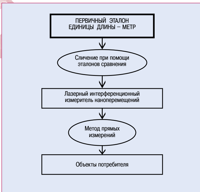
Рис.5 Схема передачи размера единицы длины в нанодиапазон для систем сканирования и позиционирования
