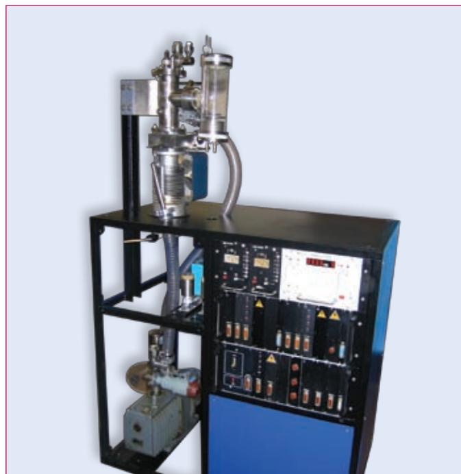
Рис. 12 Лабораторная вакуумная установка модульного типа
