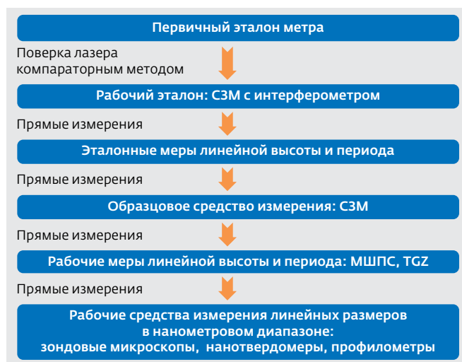
Рис.1. Схема обеспечения прослеживаемости измерений линейных размеров в нанометровом диапазоне
