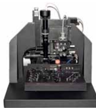
Рис.2. СЗМ "НаноСкан-3D" с трехкоординатным гетеродинным лазерным интерферометром
