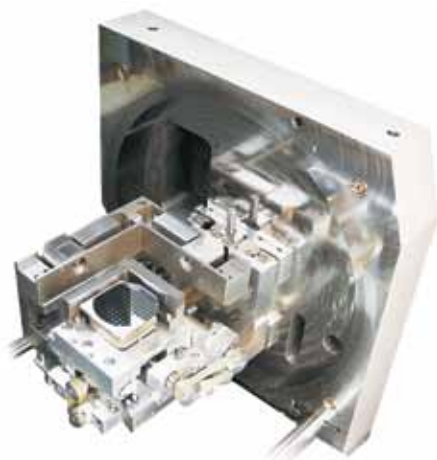
Предметный столик с лазерной интерференционной системой управления
