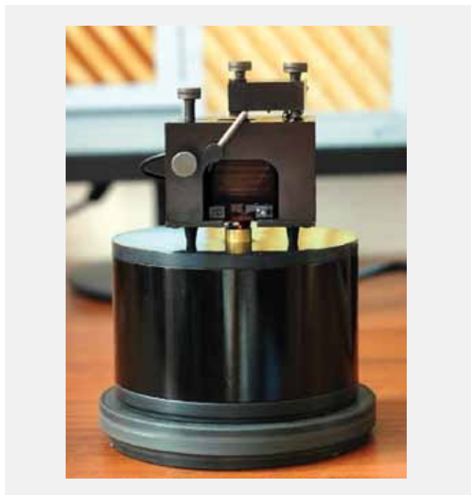
Рис.1. АСМ "ФемтоСкан" для визуализации образующихся наночастиц
