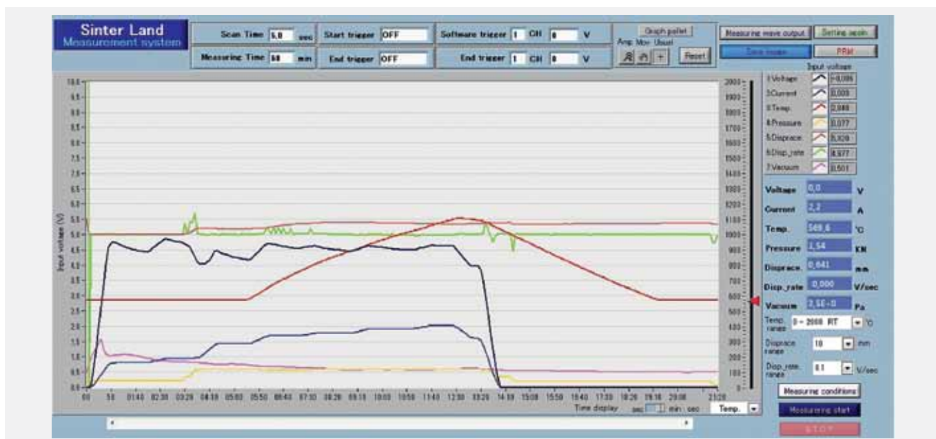
Рис.1. Режим изготовления образца 1 ( T_{max}=1100^{\circ}\text{C} , P=50\text{ МПа} )
