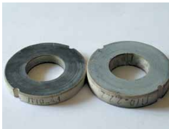
Рис.6. Параметры и типичный внешний вид образцов после трибологических испытаний пары трения керамополимер – керамополимер
