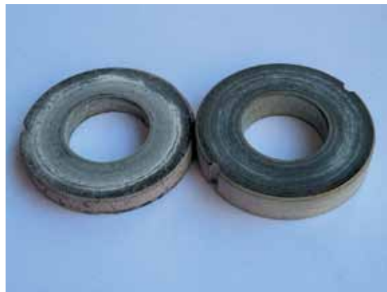
Рис.5. Параметры и типичный внешний вид образцов после трибологических испытаний пары трения оксидокерамика – керамополимер
