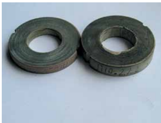
Рис.4. Параметры и типичный внешний вид образцов после трибологических испытаний пары трения оксидокерамика – оксидокерамика
