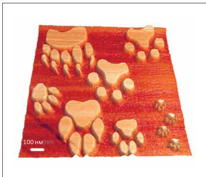
Рис. 2. Топографическое АСМ-изображение. Литография выполнена методом локального анодного окисления на графите. Высота слоя оксида графита – 0,6 нм, напряжение на игле – 7 В, частота сканирования – 1 Гц
