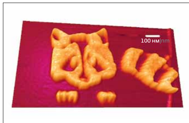
Рис.1. АСМ-изображение, полученное в режиме измерения сил трения. Литография выполнена методом локального анодного окисления на графите. Напряжение на игле – 5 В, частота сканирования – 1 Гц
