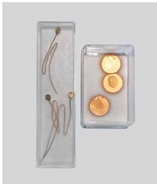
Рис.1. Пьезокерамические диски с нанесенным слоем золота. Слева – диски диаметром 4 мм, справа – диски диаме- тром 16 мм
