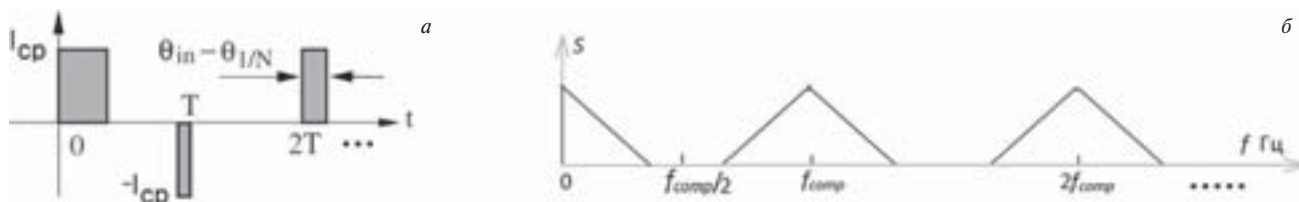
Рис. 9. Широтно-модулированные импульсы тока на выходе токового ключа (а); соответствующий им спектр треугольного модулирующего сигнала (б)
