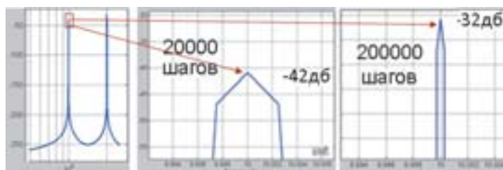
Рис. 8. Результаты потактового моделирования СДМ первого порядка. Показаны участки спектра вблизи первой гармоники 1 МГц при различном количестве шагов
