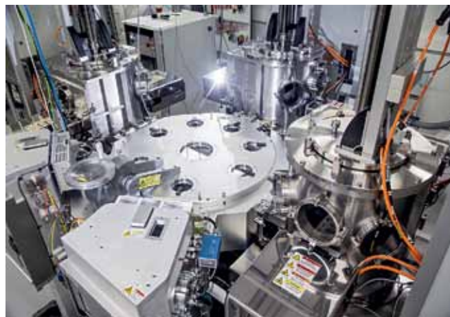
Рис.10. Оборудование Picosun P-300F с тремя модулями АСО для роста оксидов, нитридов и металлов. Оборудовано роботизированным модулем Brooks Automation MX700 и механизмами вращения кассет со 150 мм пластинами. Совместимо с SEMI S2
