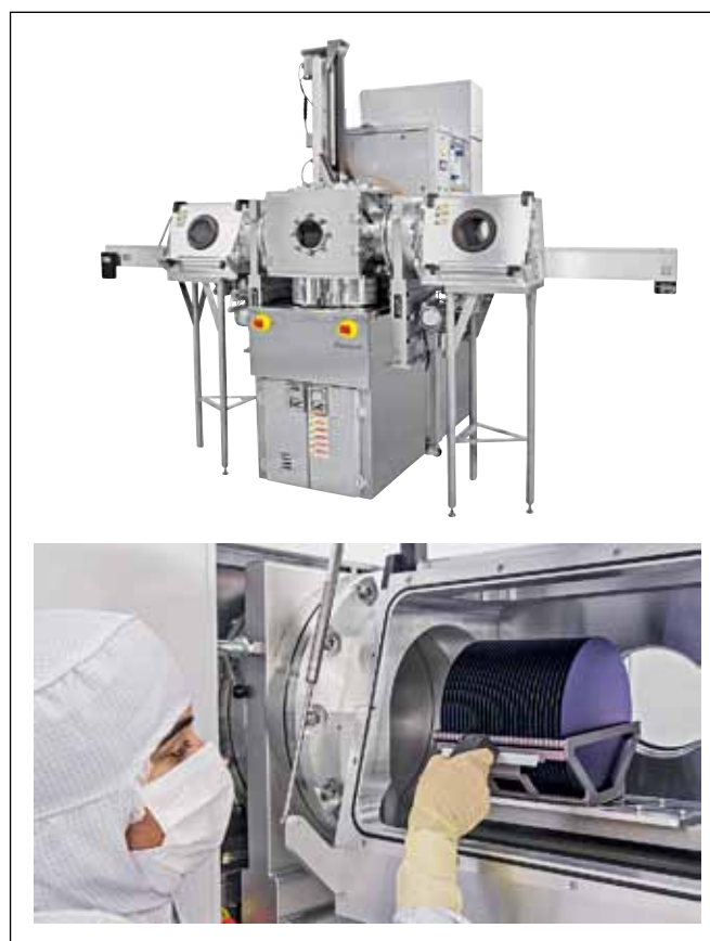
Рис.9. Оборудование Picosun P-300BV с вакуумированными шлюзовыми камерами для полуавтоматической безатмосферной загрузки кассеты с пластинами в реакционную камеру АСО Fig.9. Picosun P-300BV system with vacuum lock-chambers for semi-automatic, atmosphere-free loading of cassette with wafers into ALD reaction chamber
