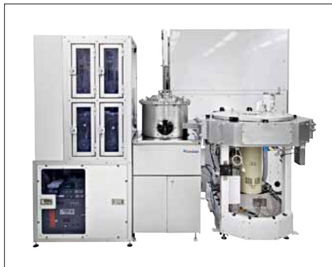
Рис.7. Оборудование Picosun P-300S для одиночной обработки 300 мм пластин. Конфигурация с вакуумным роботизированным модулем Brooks Automation Marathon 2
