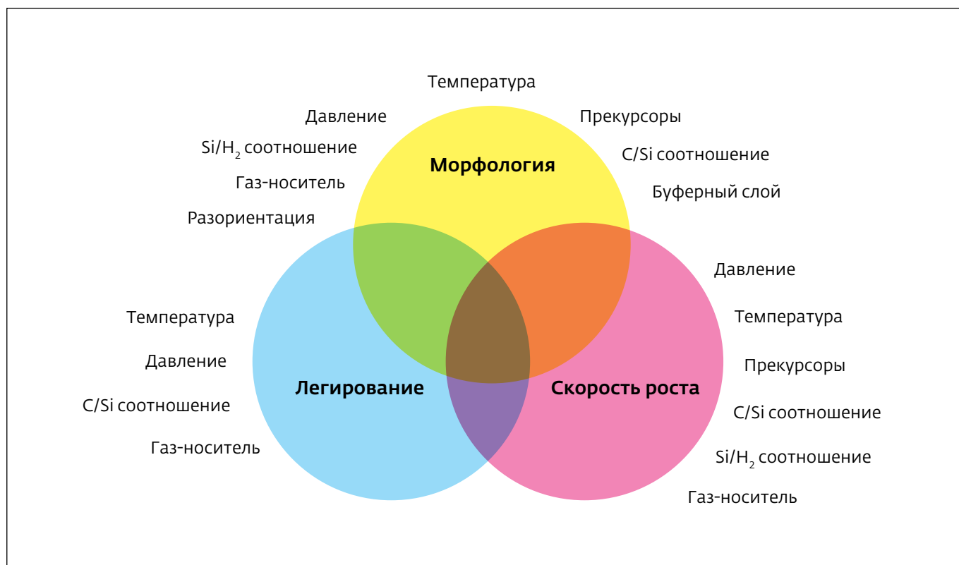
Рис.4. Параметры SiC-CVD-технологии, обеспечивающие требуемые характеристики эпислоев
