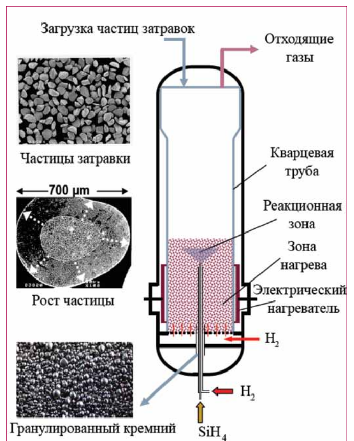
Рис.4 Реактор кипящего слоя для производства гранулированного ПКК
