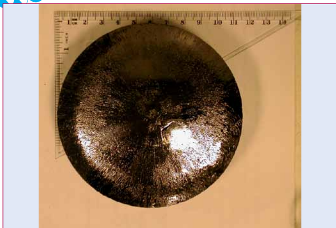
Рис.7 Экспериментальный образец слитка SiC диаметром более 100 мм (вид сверху)
