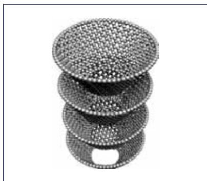
Рис.4. Углеродная нанотрубка в форме “стека чашек”
