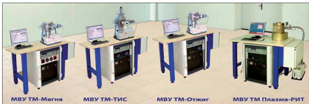
Рис.3. Малогабаритное технологическое оборудование с камерами настольного типа
