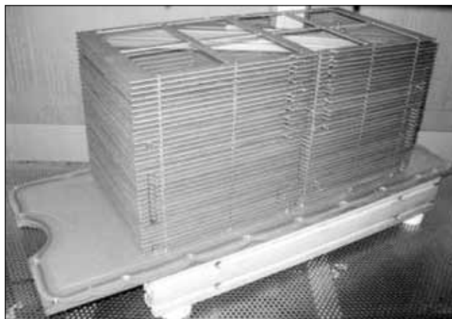
Рис.12. Двустороннее осаждение \text{TiO}_2 на установке, состоящей из 36 полок ( 240 \times 500 \text{ мм}^2 ). Однородность партии площадью более 8 \text{ м}^2 составляет \pm 2\% (установка Veneq P400A)
