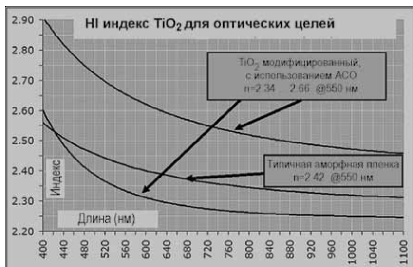
Рис.8. Коэффициент преломления \text{TiO}_2 , осажденный из \text{TiCl}_4 + \text{H}_2\text{O} в партии размером 8 \text{ м}^2
