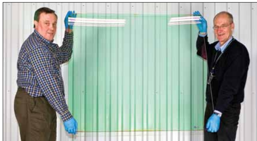
Рис.4. Стекло размерами 1200x1200 мм, покрытое с использованием ACO (встроенный модуль TFS 1200 компании Beneq)
