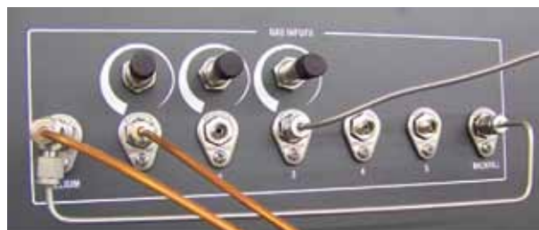
Рис.3. Стандартная система портов ввода газовых линий в анализаторе Autosorb-iQ
