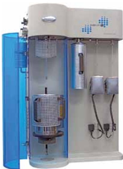
Рис.4. Autosorb-iQ-C – анализатор, оснащенный высокотемпературной печью для исследования хемосорбции
