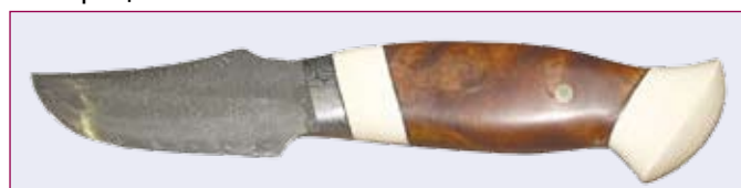
Рис.2 Нож из дамасской стали (оптическое изображение образца после полировки и гравировки). Петер Я. Штинен, www.stienen-damast.de
