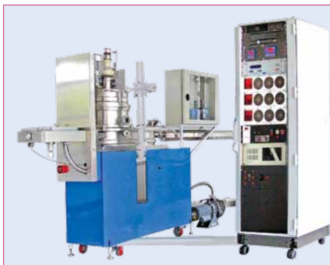
Рис.3 Установка магнетронного нанесения слоев "МАГНА ТМ-200-01"
