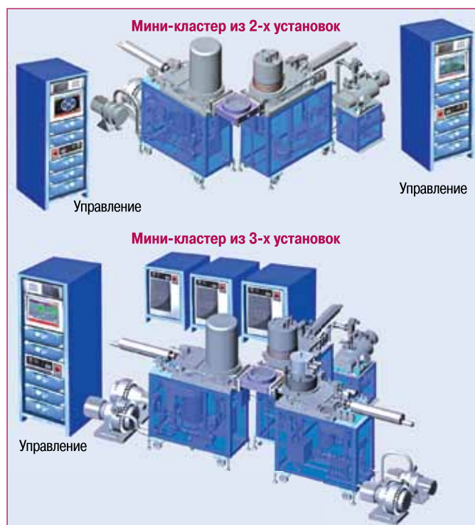
Рис. 2 Мини-кластеры с раздельным и совмещенным управлением (стыковка установок в кластер через шлюзовую камеру)
