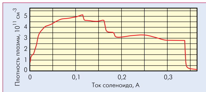
Рис.2 Экспериментальная зависимость плотности плазмы от магнитного поля в источнике с плоской антенной [5]. Срыв разряда наступает при критическом магнитном поле, величина которого растет с ВЧ-мощностью и давлением газа
