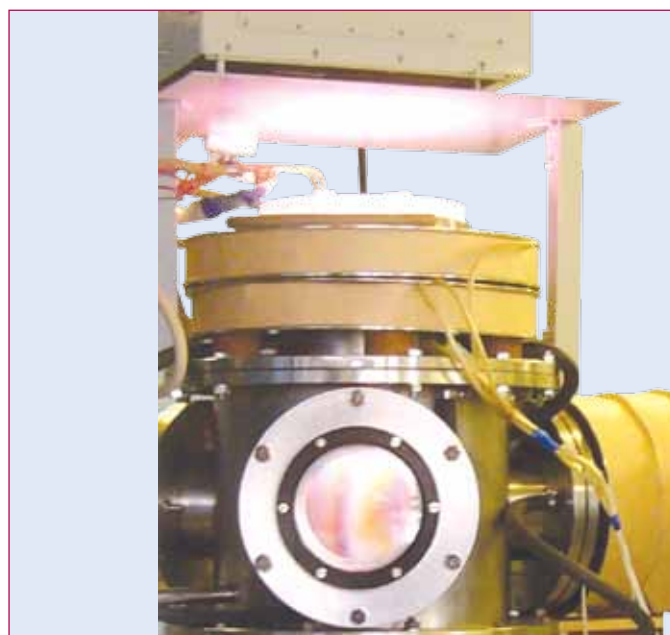
Рис. 5 Разрядная камера при включенных геликоновом и вакуумно-дуговом источниках
