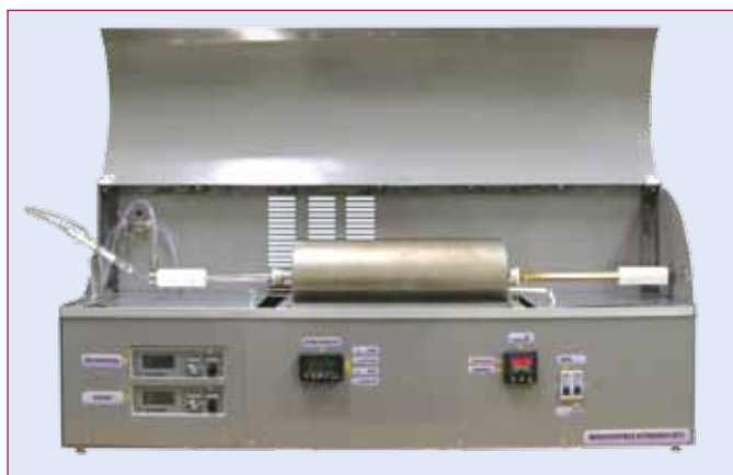
Рис.2 Установка каталитического пиролиза углеводородов УНТ-2
