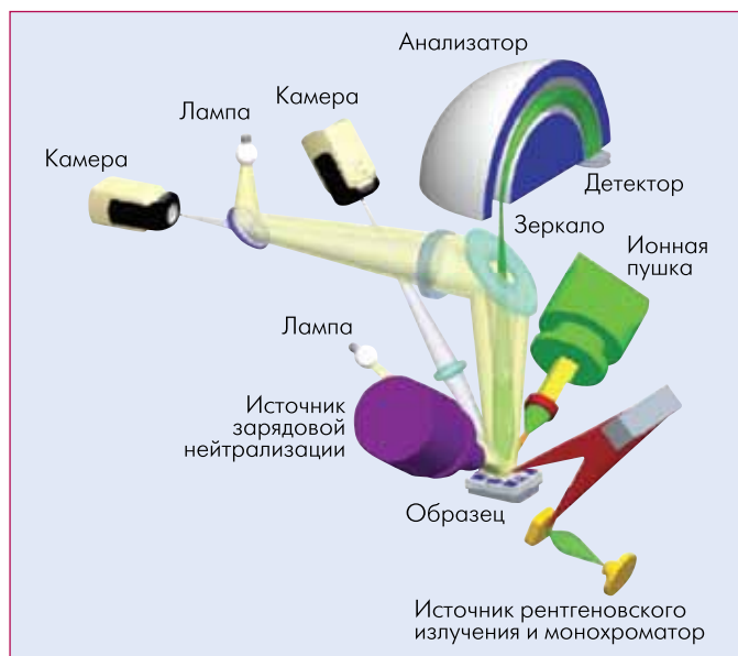
Рис.3 Геометрия расположения аналитических компонентов системы K-Alpha
