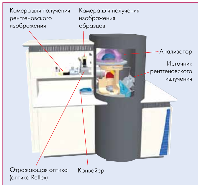
Рис.2 Расположение некоторых компонентов в системе K-Alpha
