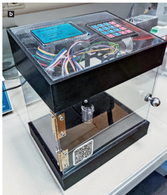
Рис.7. Макет (а) и фотография (б) установки вертикального вытягивания из коллоидного раствора Fig.7. Layout (a) and realization (b) of dip coating installation
