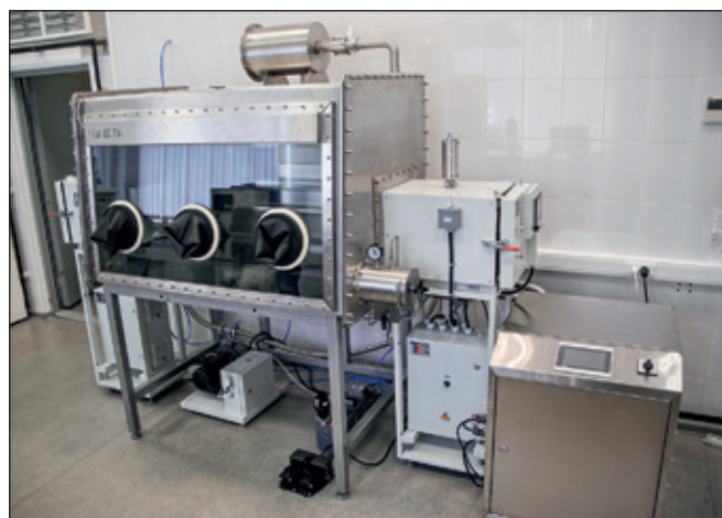
Рис.3. Оборудование для проведения процессов герметизации датчиков
