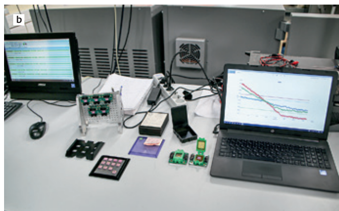
Рис.5. а – фотографии поворотного стола во внутреннем объеме термокамеры с установленными датчиками; б – рабочее место для регистрации и анализа данных
