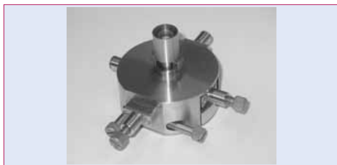
Рис. 12 Юстировочное устройство с фокусирующей поликапиллярной линзой
