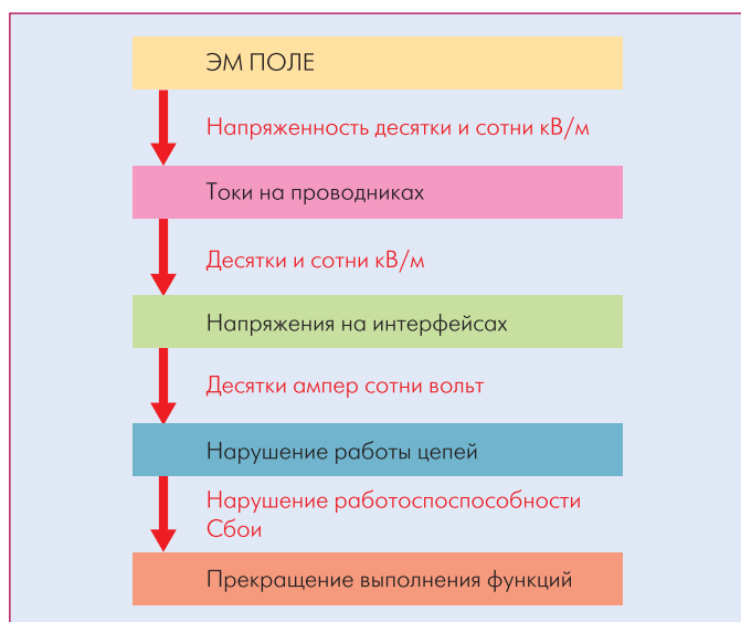
Рис.1 Схема прохождения ЭМИ, приводящего к деградации аппаратуры [1]
