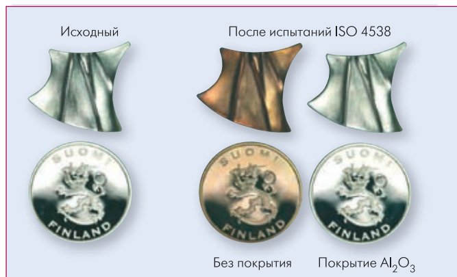
Рис.6 Образцы изделий с интерференционным окрашиванием
