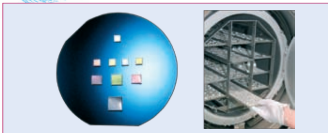
Рис.7 Результаты теста серебряных изделий с защитным покрытием Al_2O_3
