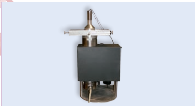
Рис.3 Разборная рентгеновская трубка с сцинтилляционным детектором и устройством для съемки в вакууме на рентгеновскую пленку
