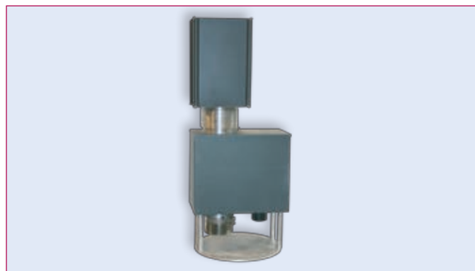
Рис. 1 Разборная рентгеновская трубка с рентгеновским детектором в защитном кожухе
