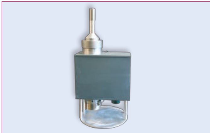
Рис.2 Разборная рентгеновская трубка с сцинтилляционным детектором
