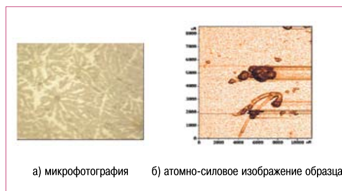
Рис.3. Углеродный композит, полученный на установке каталитического пиролиза
