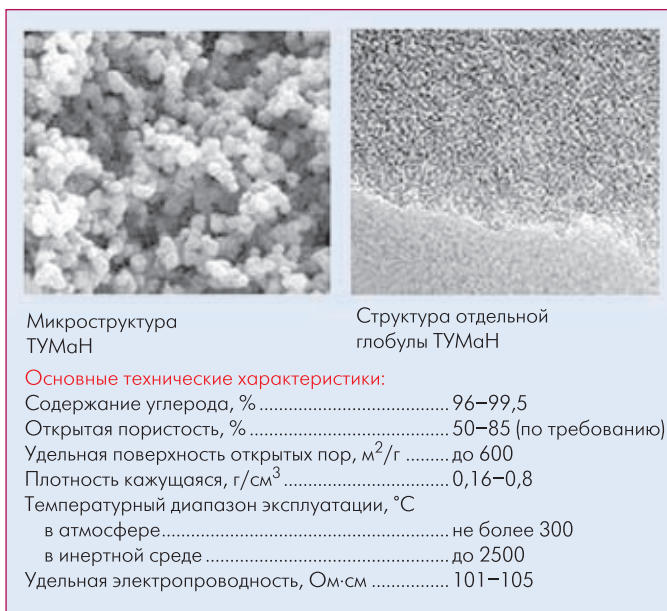
Рис.3 "ТУМаН" – технический углеродный материал с нанопорами
