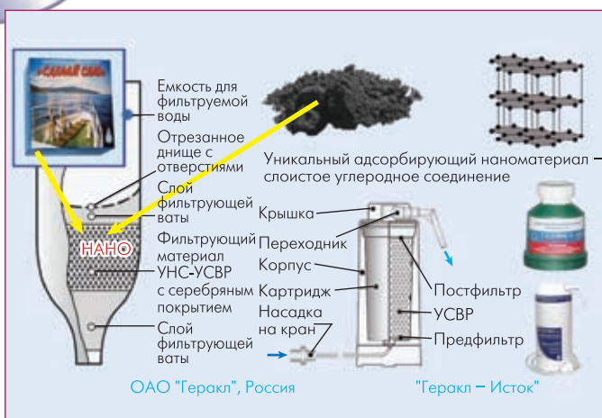
Рис. 8 Применение нанотехнологий для очистки и дистилляции воды в бытовых и полевых условиях
