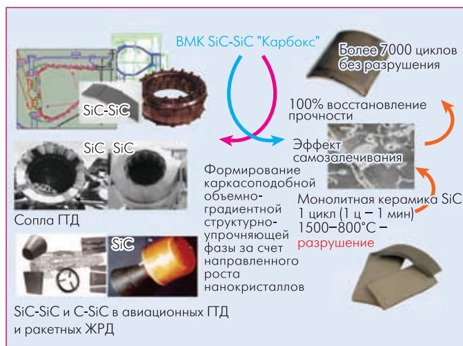
Рис. 1 Керамические наноструктурированные материалы конструкционного назначения (по материалам ФГУП "ВИАМ")
