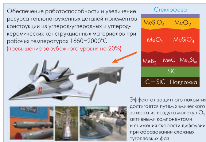
Рис. 2 Многоуровневая система высокотемпературной антиокислительной защиты на основе наноструктурированных материалов (по материалам ФГУП "ВИАМ")
