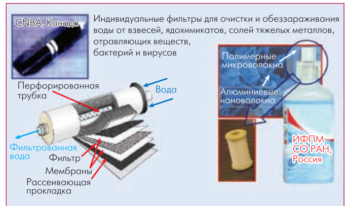
Рис.7 Типовые конструкции фильтров водоочистки с применением наноматериалов
