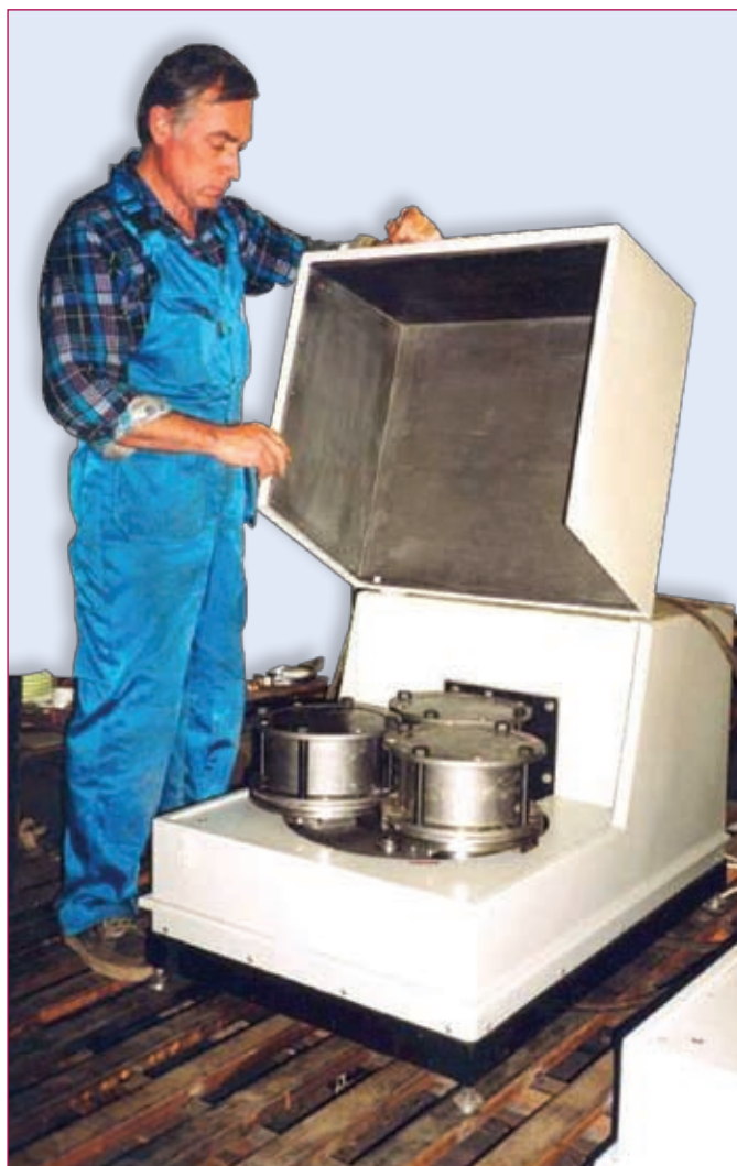
Рис. 1 Планетарная мельница периодического действия МПП-2 (ТТД)
