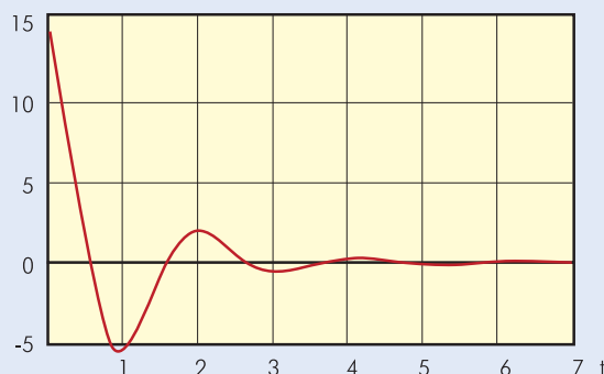
Рис.2 Кривая затухания механических колебаний системы с КМ (а) и соответствующий ей закон затухания (б) ( x – перемещение системы в момент времени t ; x_0 – начальное перемещение соответствует величине 1/2 \cdot A_0 ; x'_0 – начальная скорость колебания системы; p_1 – частота колебаний системы; J – импульс единичной силы, m – масса системы, \tau_1 – период затухающих колебаний; A – амплитуда колебаний)
