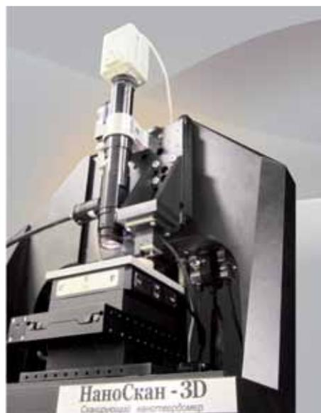
Рис.1. Сканирующий нанотвердомер "НаноСкан-3D"
