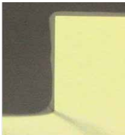
Рис.3. Отверстие, покрытое резистом методом распыления
