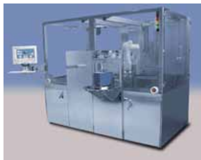
Рис.5. Комплекс для нанесения резиста методом NanoSpray
