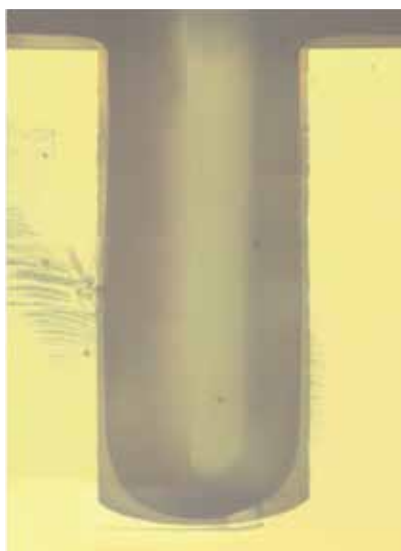
Рис.4. Отверстие, покрытое резистом методом NanoSpray
