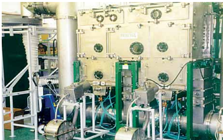
Рис. 7. Рулонная вакуумная ионно-плазменная установка для формирования наноструктурных покрытий
