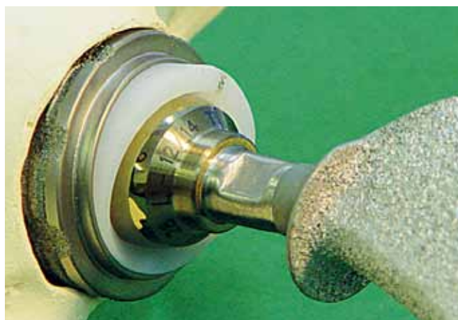
Рис. 10. Узел трения эндопротеза тазобедренного сустава с головкой из титанового сплава
