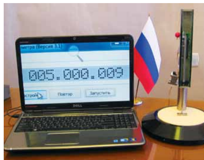
Рис.3. Нанометр НДГ-70: под сапфировым шупом находится 5-мм концевая мера длины. Последняя цифра на экране ПК относится к единицам нанометра
