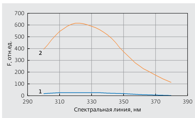
Рис.4. Спектр триптофановой флуоресценции белков митохондрий в водном растворе: стандартная кювета (1); зеркальная кювета с диагональной кварцевой пластинкой (2)
