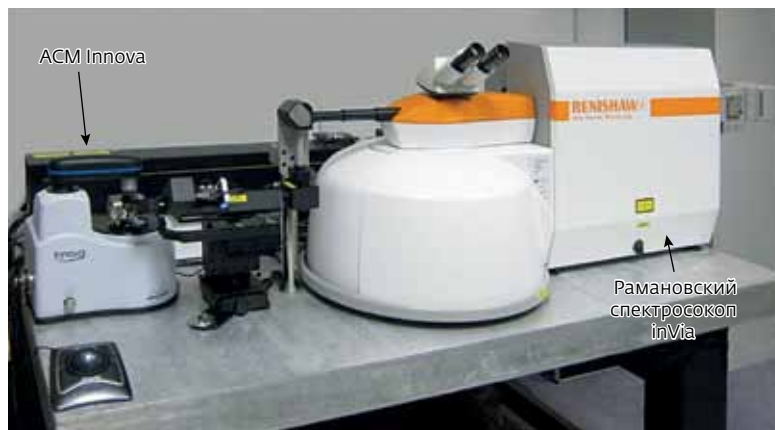
Система Innova-IRIS: АСМ Innova компании Bruker и рамановский спектроскоп inVia компании Renishaw
