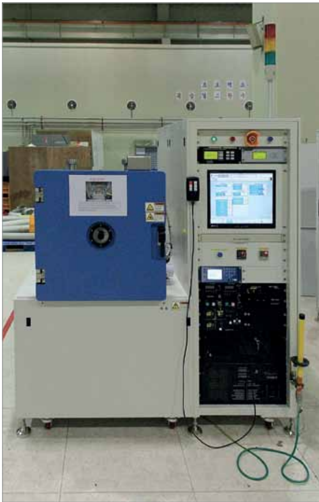
Рис.5. Установка электронно-лучевого напыления E-BeamEvaporator
