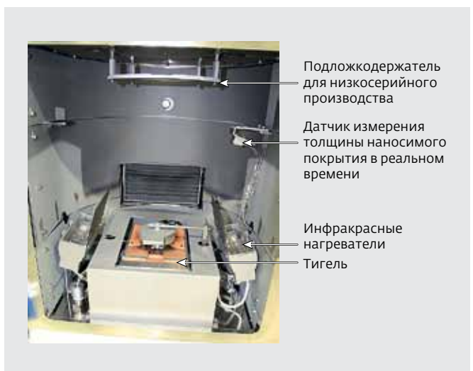
Рис.7. Рабочая камера установки E-BeamEvaporator
