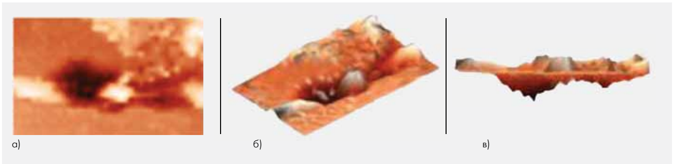
Рис.2. АСМ-изображения дефекта на поверхности образца: а – двухмерное; б, в – трехмерное
