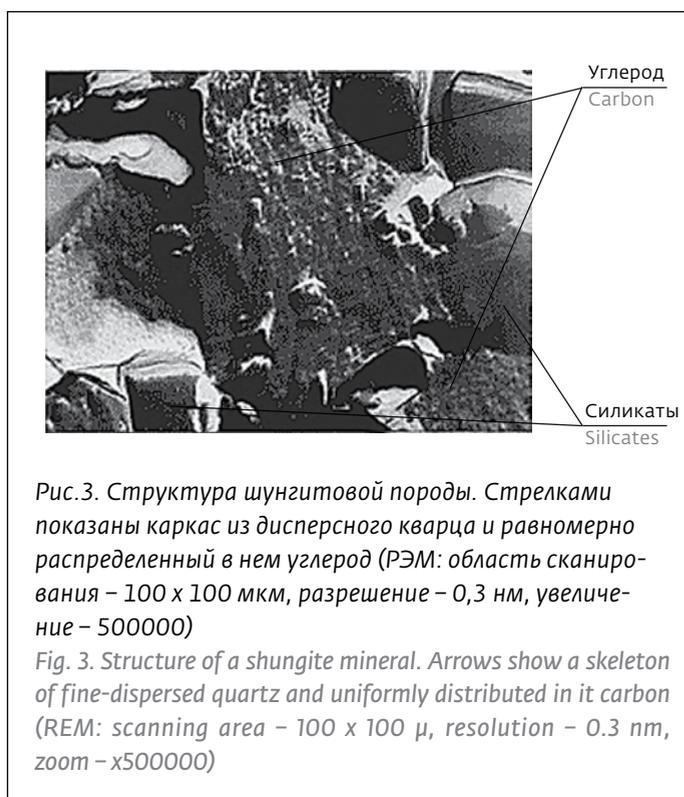
Рис.3. Структура шунгитовой породы. Стрелками показаны каркас из дисперсного кварца и равномерно распределенный в нем углерод (РЭМ: область сканирования – 100 x 100 мкм, разрешение – 0,3 нм, увеличение – 500000)
