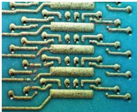
Рис.5. Пример дефектов (обведены красным) при печати через тонкую сетку после обжига (проводник/зазор – 100 мкм) Fig.5. Example of defects (outlined by red color), which appear during printing through a thin grid after burning (conductor/gap – 100 micrometers)
