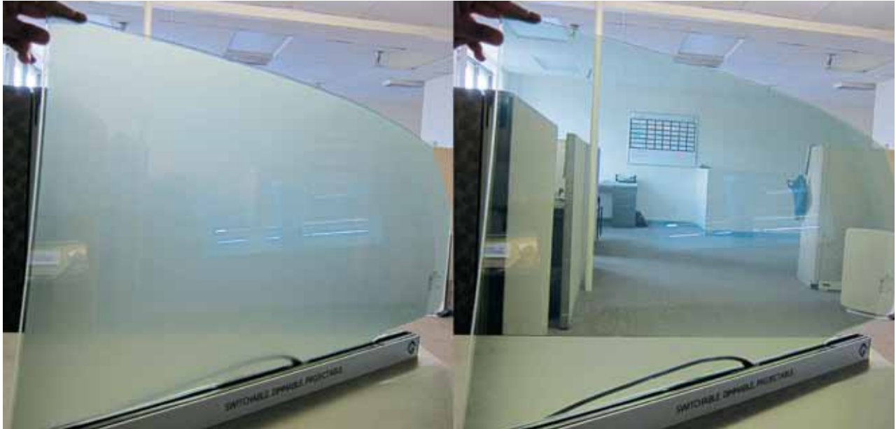
Рис.6. Демонстрация электрохромных стекол (фото: Glass Apps LLC) Fig.6. Demonstration of electrochromic glass (photo: Glass Apps LLS)
